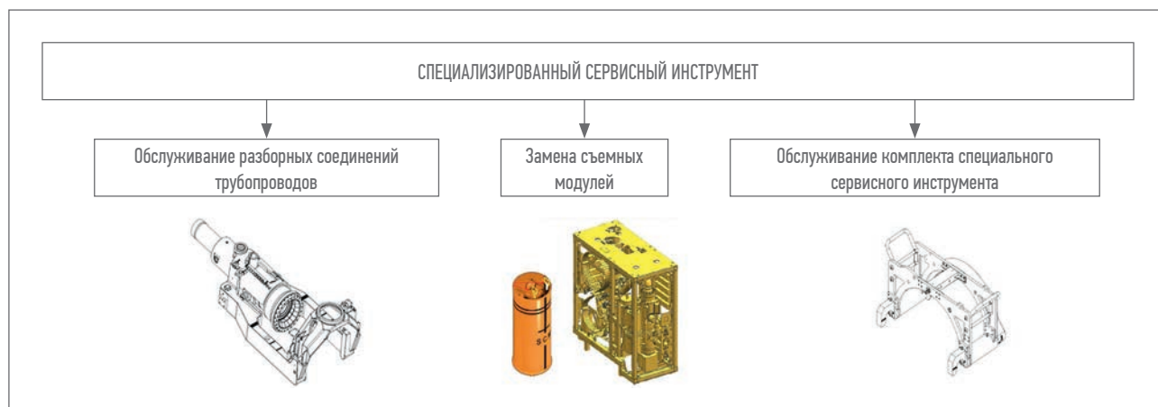
Рис. 7. Специализированный сервисный инструмент для выполнения ремонта оборудования подводного добычного комплекса
