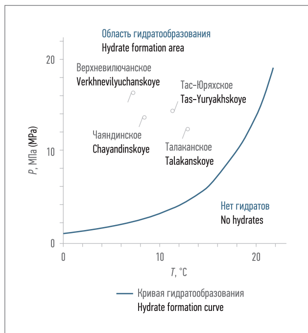
Рис. 1. Пластовые условия восточносибирских месторождений в сравнении с равновесными условиями гидратообразования газовой смеси с относительной плотностью 0,6 по воздуху [4]. Fig. 1. Reservoir conditions of the West Siberian fields compared with the equilibrium hydrate formation conditions of a gas mixture with a relative air density of 0.6 [4].
