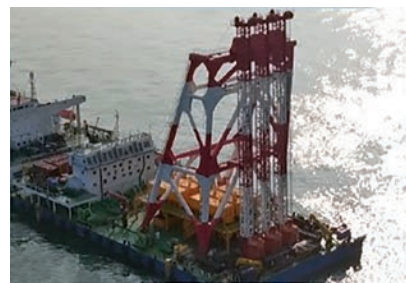
Рис. 8. Самоходная баржа для глубинного перемешивания грунта (общий вид) [8] Fig. 8. Self-propelled barge for the deep soil mixing (general arrangement) [8]
