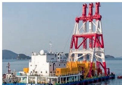
Рис. 8. Самоходная баржа для глубинного перемешивания грунта (общий вид) [8] Fig. 8. Self-propelled barge for the deep soil mixing (general arrangement) [8]
